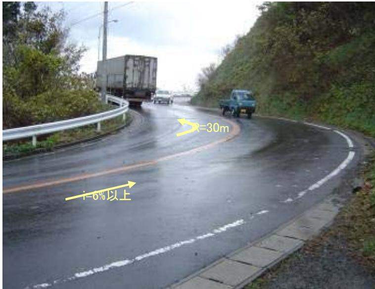
・道路幅員が狭く、曲がりくねりった( $R_{min}=10m$ )区間が700m以上連続し、通行車両が危険な状況となっている。
