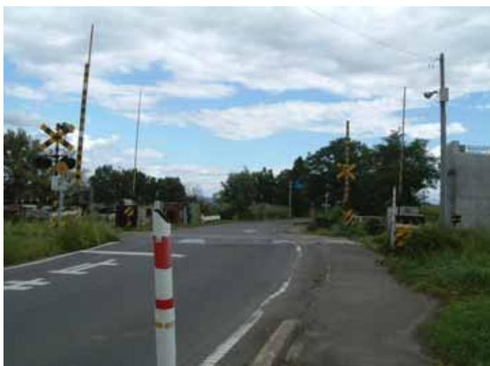
・JR五能線との平面交差に対して、平面線形が悪い(踏切の奥が右カーブ)ため見通しが悪い。
