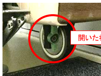
排水レバーの下に受け皿を置いてレバーをひねって水を出す。出し終わったらレバーは戻す。
