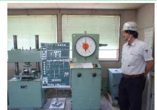
[アンカー定着材（セメントカプセル）圧縮強度試験]
