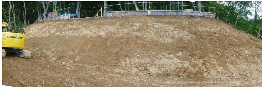
写真-2 礫質土（八甲田泥流堆積物）
