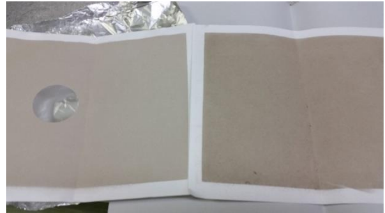
図 5 石英繊維ろ紙上の粉じんの捕集状況 (左：H31.4、右：R1.5)
