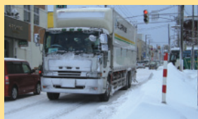
路肩堆雪による幅員狭小状況
