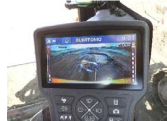
【自動TSを用いた動態観測等】 【バックモニターを用いた安全管理】
