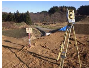
【自動TSを用いた動態観測等】 【バックモニターを用いた安全管理】
