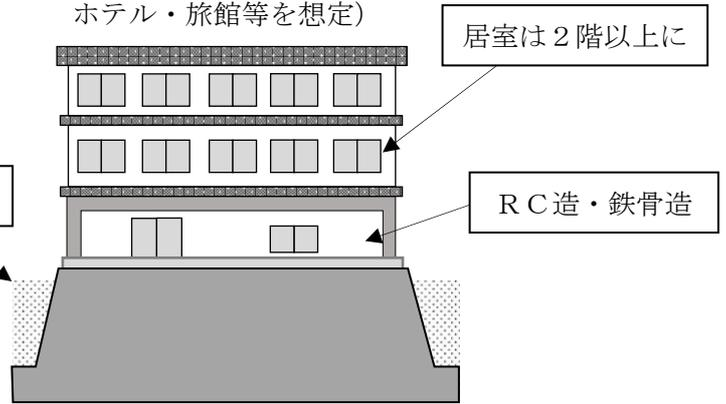
主要構造部をRC造・鉄骨造とし、基準高以下の部分を居室、病室、寝室等
