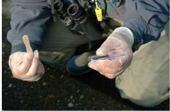
試料を入れるサンプル管と木製スプーン
