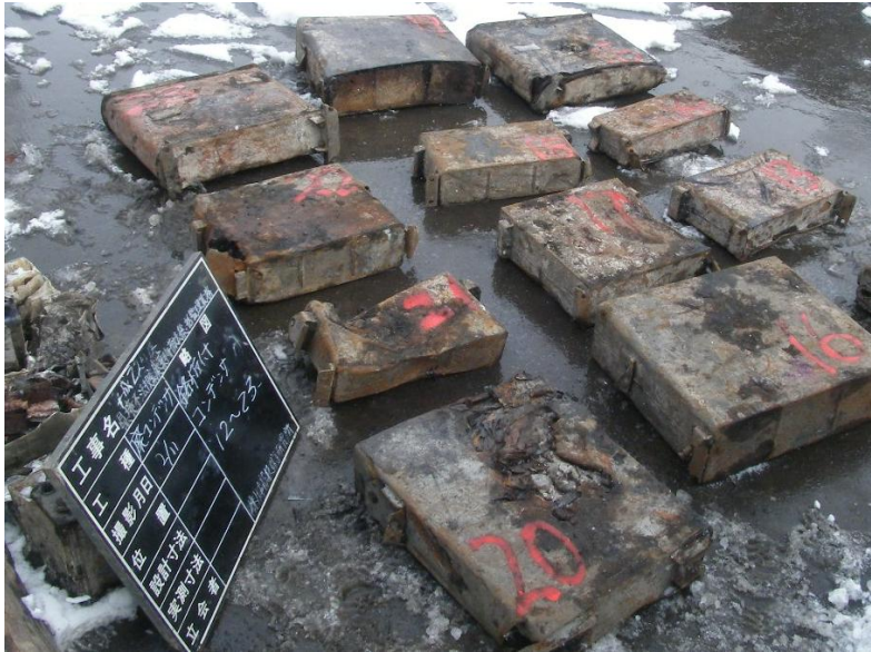
④ 銘板有りPCB不使用廃コンデンサ11個 (No.13~23)
