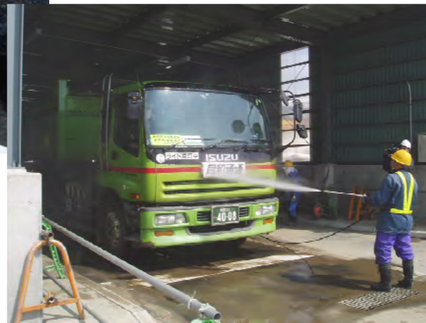
高圧洗車装置
